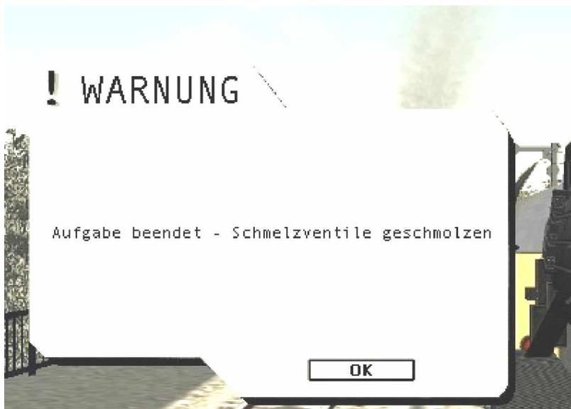
Abb 1a Das passiert bei Wassermangel im Kessel. (Screenshot B. Schmidt)
